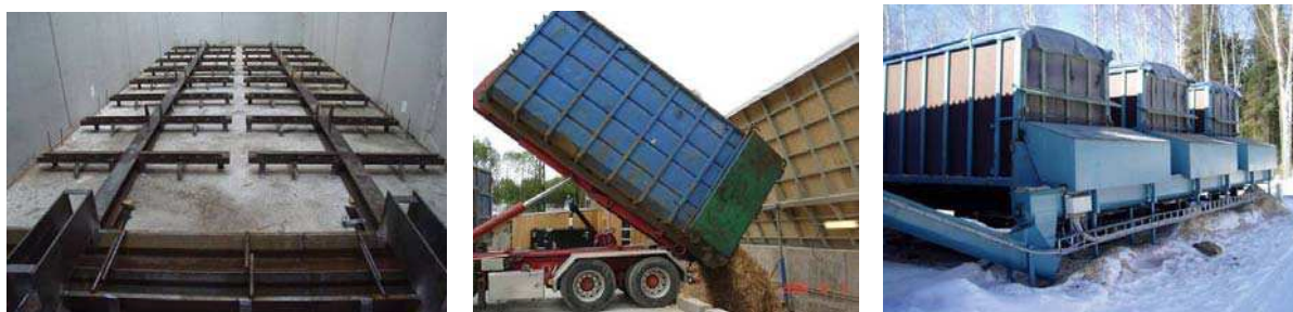
Hydraulisk stangmaterer, tipping av flis, containerløsning (foto: SWECO Norge AS, Biovarme AS)
