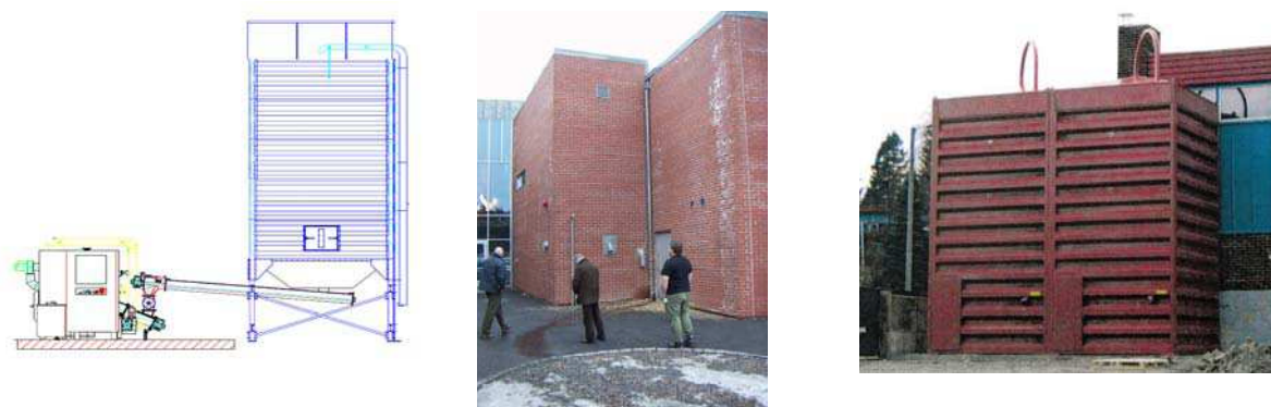
Pelletssilo – prinsipp og visuell utforming (tegning: SGP Biovarme AS, foto; SWECO Norge AS)
